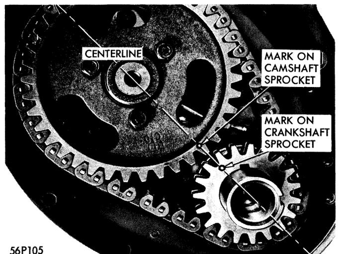
**Figure 51—Timing Marks—6 Cylinder Engine**
