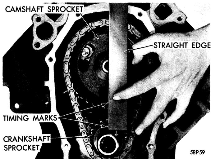
**Figure 50—Timing Marks—V-8 Engine—
