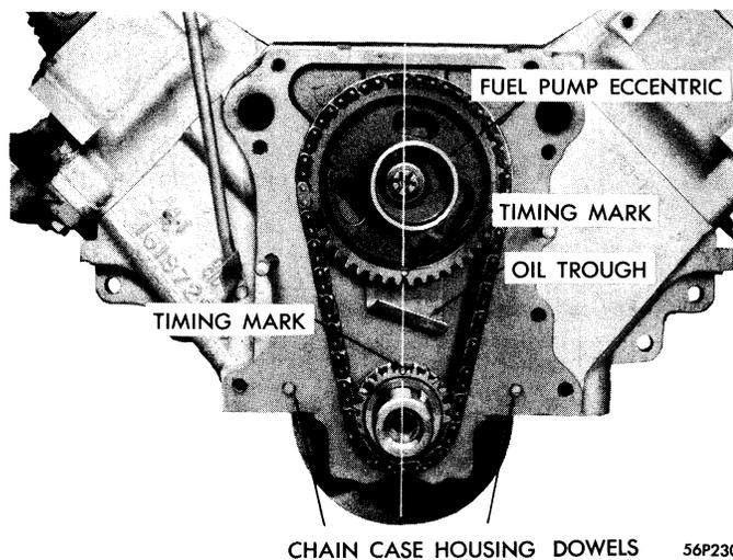
**Figure 49—Timing Marks—V-8 Engine**
